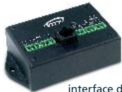
interface de connexion reliée au VIMATY 35S via un câble RJ45
